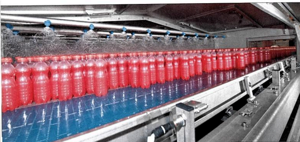
PET-Getränkeflaschen im Tunnelkühler: Oben sind die Snap-In-Vollkegeldüsen sichtbar, die die Behälter zu Abkühlungszwecken gezielt bespritzen.
