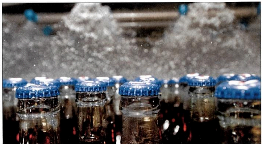
Glasflaschen im Pasteur: Hier zeigen die Snap-In-Spritzdüsen aus Edelstahl ihre Vorteile.
