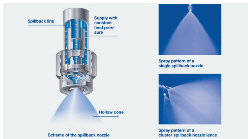
Esquema de una boquilla "spillback" de Lechler
